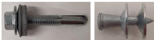
Obr. 4: Zkoušený samovrtný šroub a nastřelovací hřeb Fig. 4: Tested self-drilling screw and powder-actuated fastener
