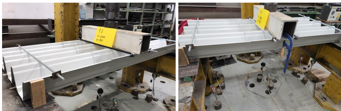
Obr. 9: Instalace zkušební vzorku a měření deformací potenciometry Fig. 9: Installation of the test specimen and measurement of the deformation by potentiometers
