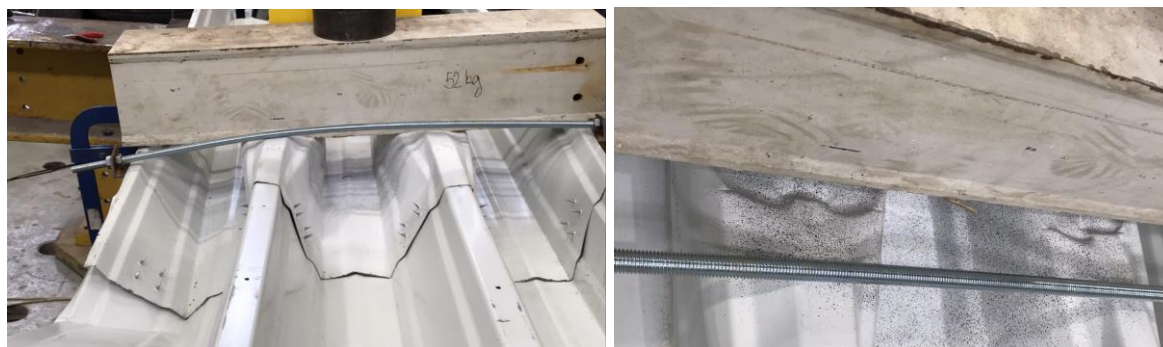
Obr. 11: Deformace vnějších vln a borcení stojiny pod zatěžovacím nosníkem Fig. 11: Deformation of the webs and web crippling under the load bearing profile
