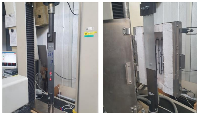
Obr. 2: Zkoušky přípojů za běžné teploty (vlevo) a teploty 600 °C (vpravo)
