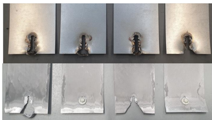
Obr. 3: Způsob porušení šroubu a plechu 0,75 mm: 350 °C (nahore) a 600 °C (dole)
