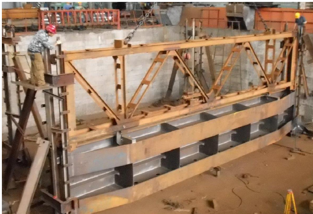
Obr. 1 Funkční test jeřábu a hradicího elementu v dílně před aplikací povrchových úprav
